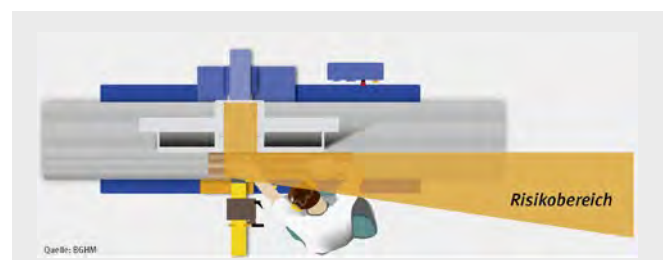
Abb. 3.1.9-02 Risikoaufenthaltsbereich an einer Abrichthobelmaschine
