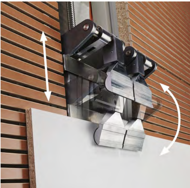
Abb. 3.1.2-04 Klemmvorrichtung für Besäumschnitt
