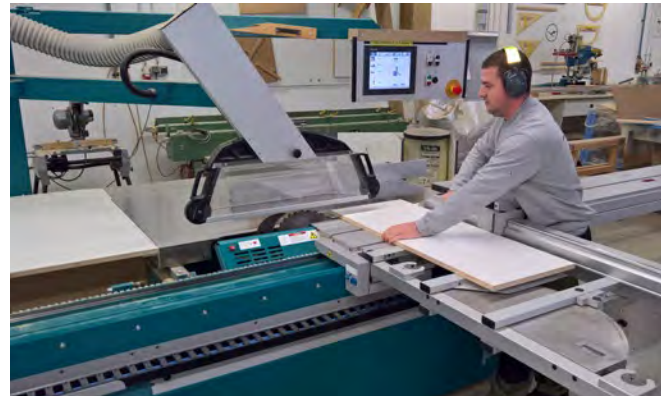
Abb. 2.2.2-03 Betrieb einer Formatkreissäge
