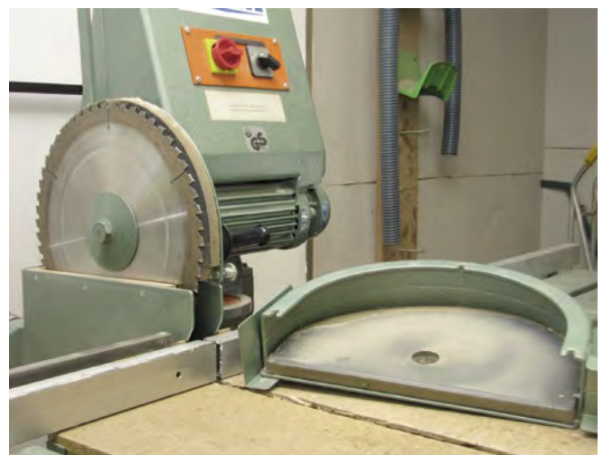
Abb. 3.1.5-07 Auskleidung an Schutzhaube zur Lärmreduzierung
