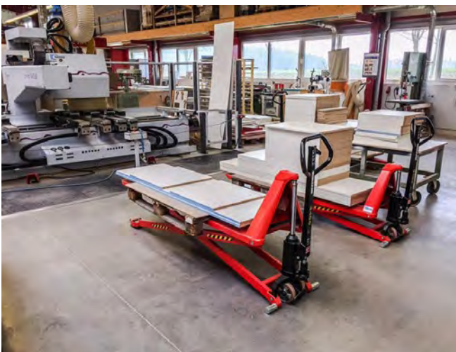
Abb. 3.2.1-04 Hubwagen mit Scherenhubfunktion
