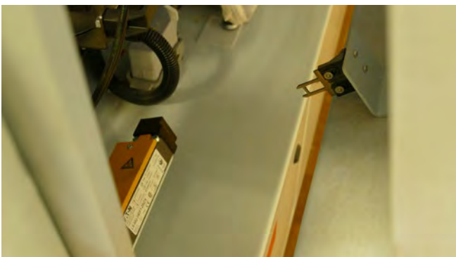
Abb. 3.1.12-03 Elektrisch verriegelte bewegliche Schutzeinrichtung mit Zuhaltfunktion für Kapp- und Bündigfräsaggregate
