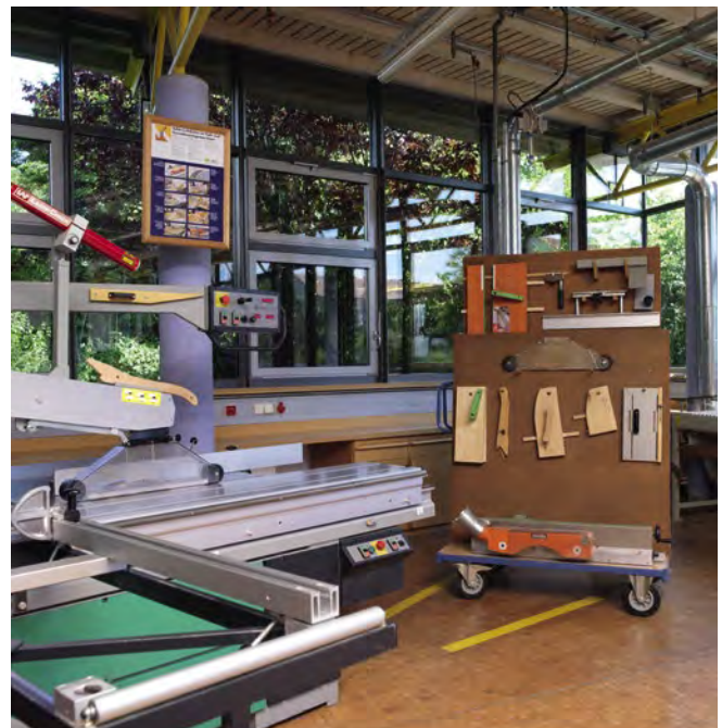
Abb. 2.2.2-04 Formatkreissäge mit zugehörigen Schutzvorrichtungen
