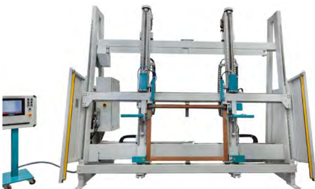
Abb. 3.1.15-04 Rahmenpresse mit Lichtvorhang
