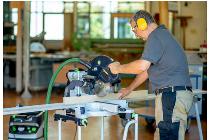
Abb. 3.1.4-02 Mobile Kapp-/Gehrungskreissägemaschine mit zusätzlicher Werkstückauflage
