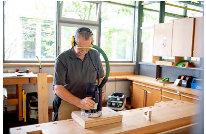
Abb. 3.3.2-02 Maschine an Absaugeinrichtung anschließen
