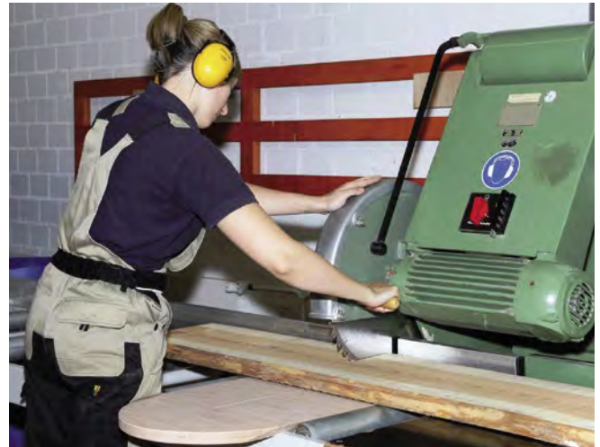
Abb. 3.1.5.06 Handhaltung beim Sägevorgang an einer Pendelkreissägemaschine
