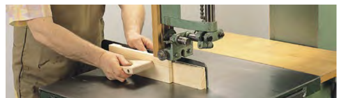
Abb. 3.1.6-10 Sägen kurzer Werkstücke mit Zuführhilfe
