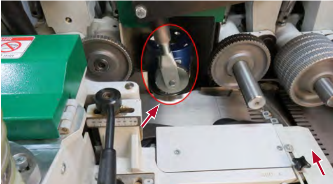
Abb. 3.1.13-03 Verdeckung einer hinteren Vertikalspindel vorge-setzter Druckrolle
