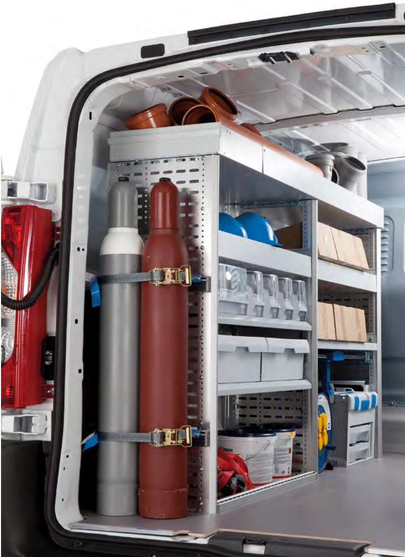
Abb. 3.5.6-01 Fahrzeug mit Einrichtungen zur Ladungssicherung
