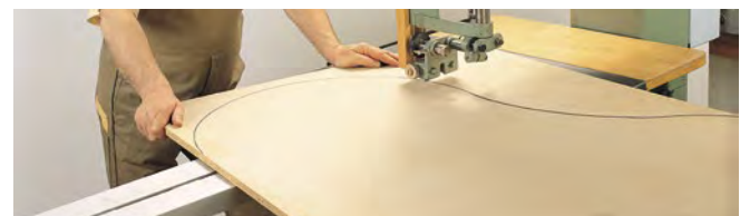
Abb. 3.1.6-09 Sägen sperriger Werkstücke mit zusätzlicher Tischverbreiterung
