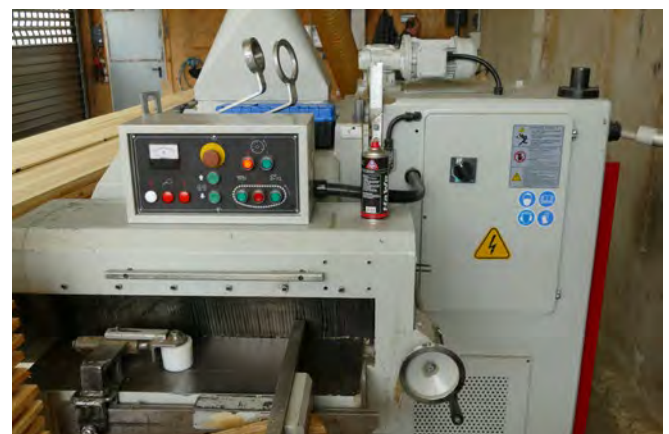
Abb. 3.1.14-04 Einschubbereich mit Splitterfänger
