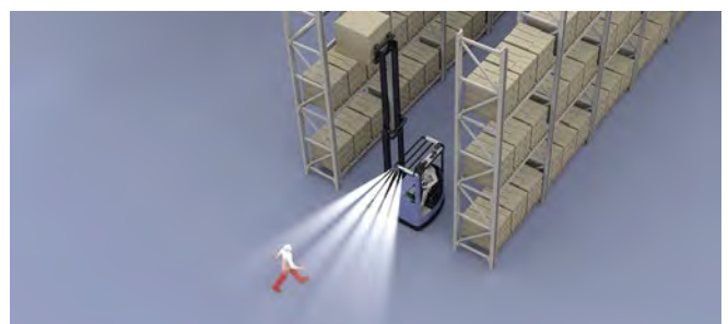
Abb. 3.4.4-04 Personenerkennung in einem Schmalganglager
