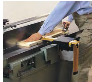
Abb. 3.1.9-07 Schwenkbarer Hilfsanschlag (Abrichten schmaler Leisten)
