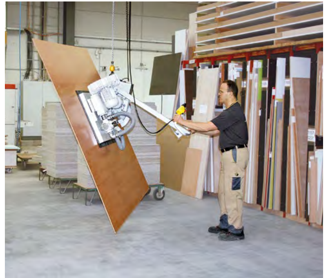
Abb. 3.1.2-08 Vakuum-Hebegerät für das Plattenhandling
