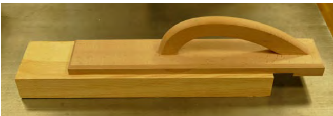
Abb. 3.1.9-05 Zuführlade und Schiebehholz für kurze Werkstücke
