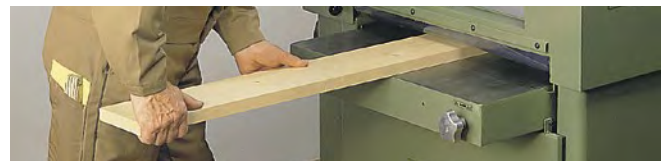
Abb. 3.1.10-05 Werkstück auf Dicke hobeln
