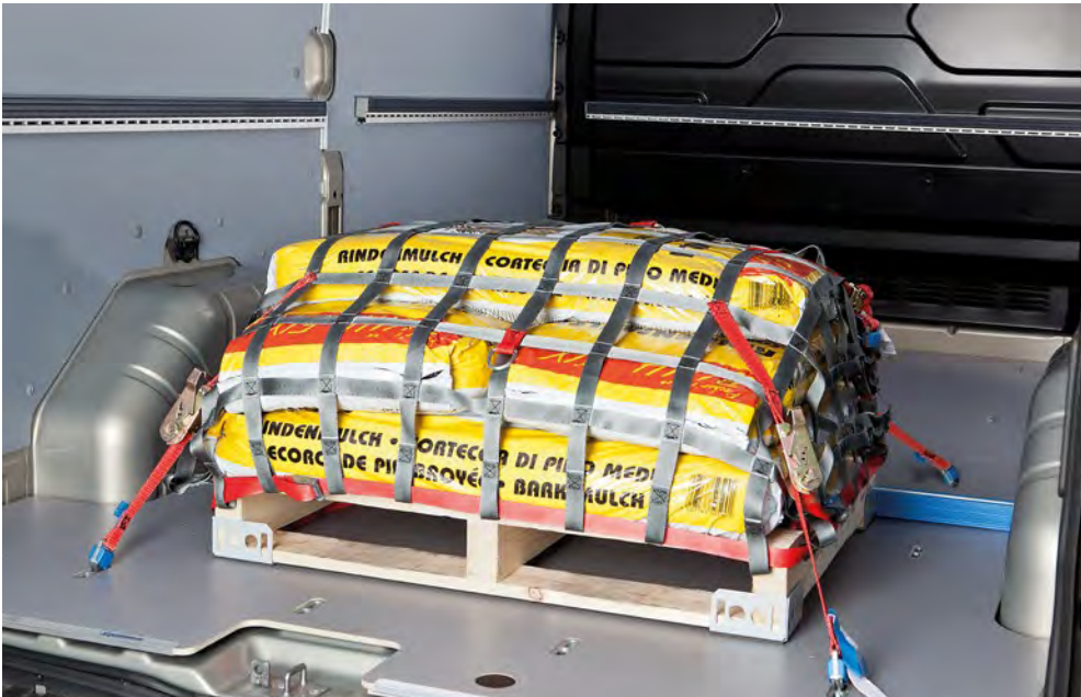
Abb. 3.5.6-02 Niederzurren eines freistehenden Ladungsguts
